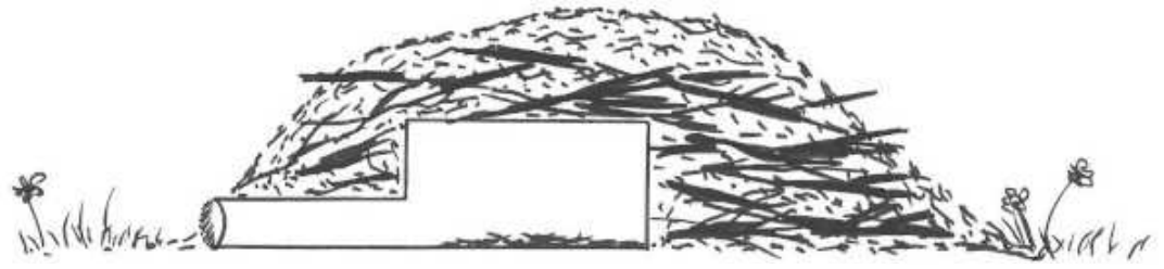
Gîte simple pour hérisson d'Europe. L'entrée de la caisse en bois doit mesurer 15 cm de côté pour empêcher les chiens et/ou les renards de pénétrer dans le nid - dessin © Nicolas Macaire LPO
