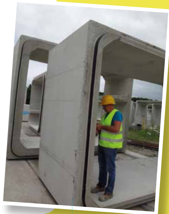
Contrôle de la fabrication d'un élément témoin (cadre fabriqué à l'usine BONNA SABLA à Cinq Mars la Pile)
